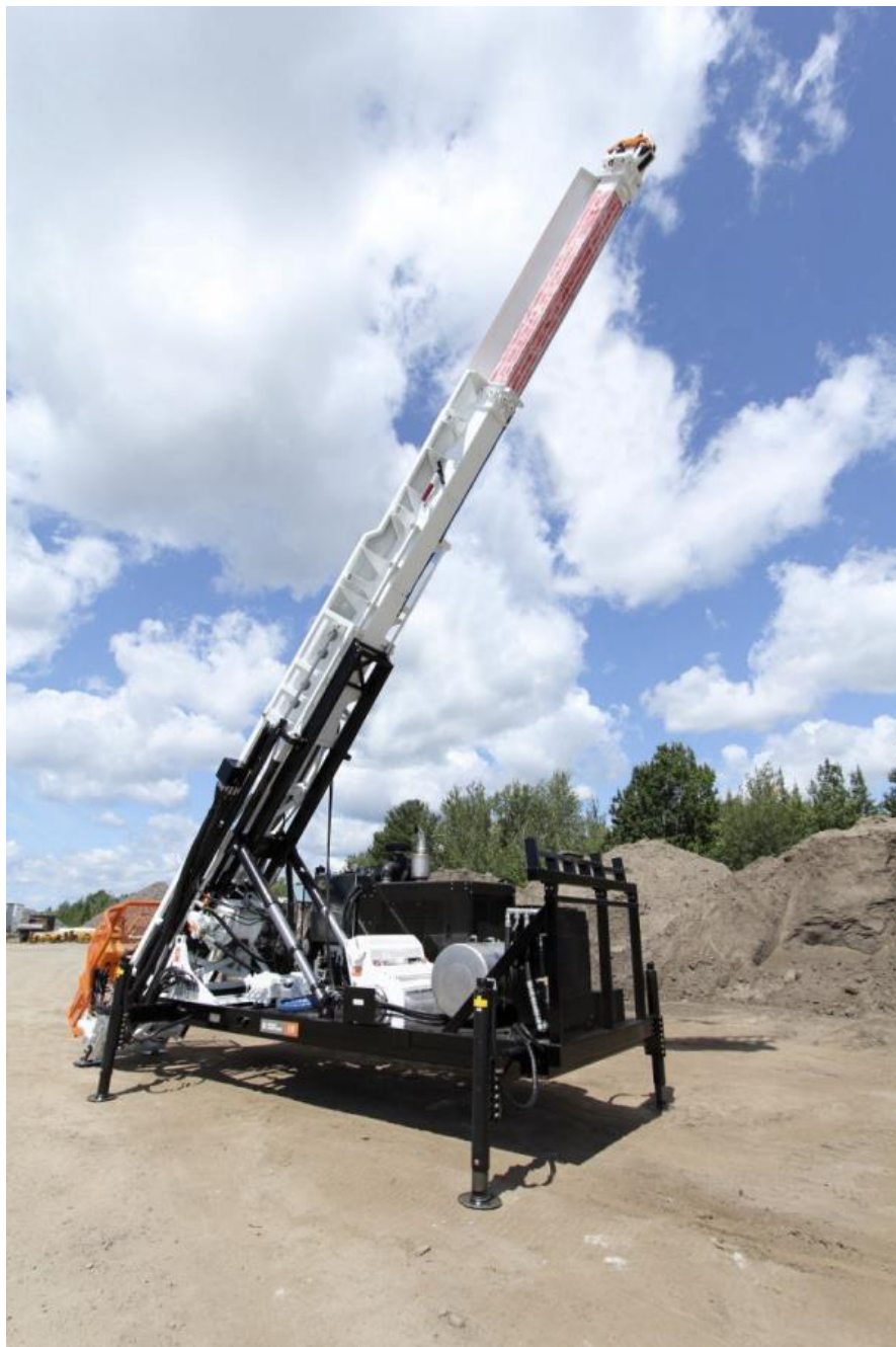
Рисунок 2.3 Буровая установка Voart Longer LF90
