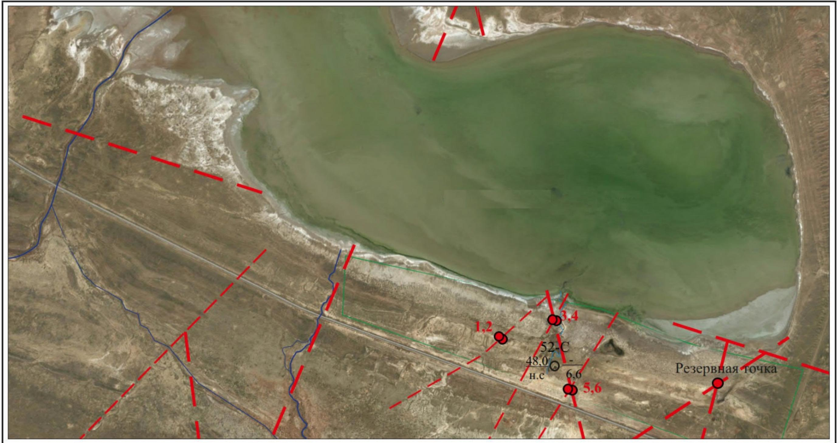
Участок работ    ● Проектная скважина    ○ Существующая скважина    - - - Разломы, выявленные путем дешифрирования
