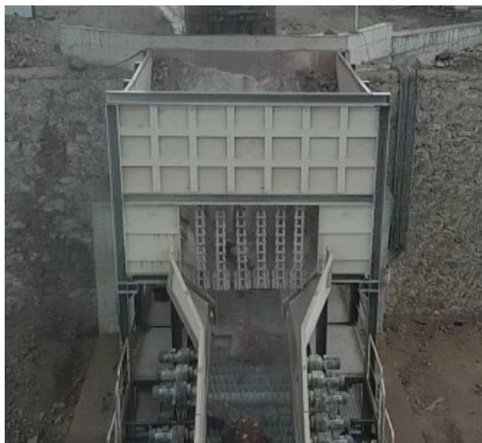
Рисунок 2.4 – Приемный бункер-питатель
