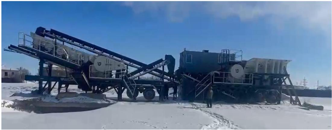
Рисунок 2.2 – Мобильная первичная дробильная установка UMA90M
