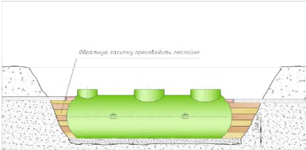
Рис.3. Послойная обратная засыпка оборудования
