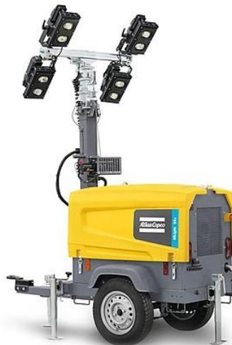
Рис. 7.2 – Осветительная мачта типа Atlas Copco V4+
