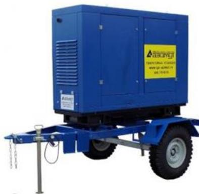
Рис. 7.1– Передвижная дизельная электростанция типа ЭД-...-Т400-1РПМ11
