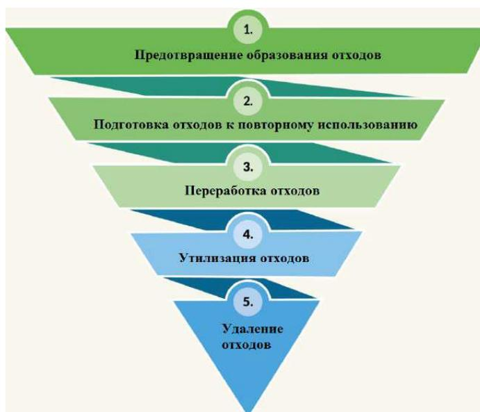
Рис. 1.14 – Принцип иерархии отходов
