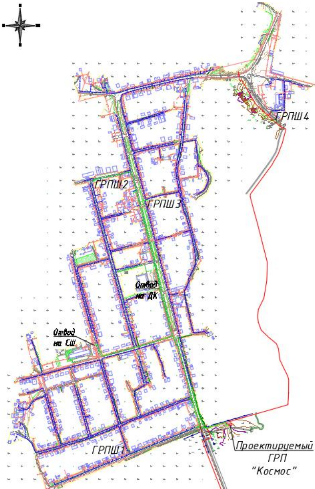
Рисунок 1.2 Схема расположения газопровода и ГРПШ внутри поселка
