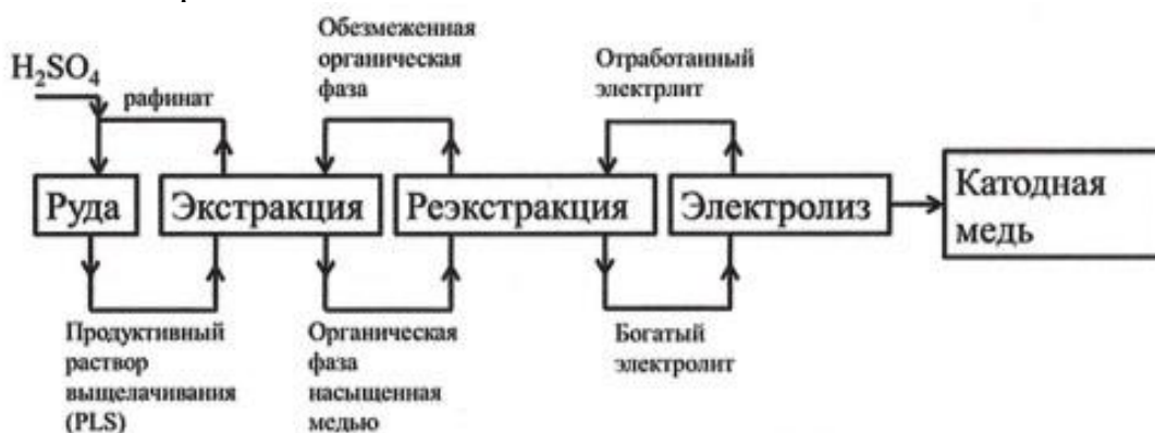
Рис. 2.1 Полная гидрометаллургическая схема производства меди
