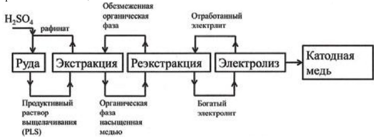
Рис. 2.1 Полная гидрометаллургическая схема производства меди
