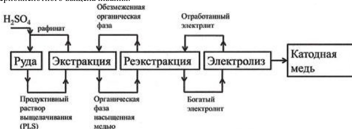
Рис. 2.1 Полная гидрометаллургическая схема производства меди
