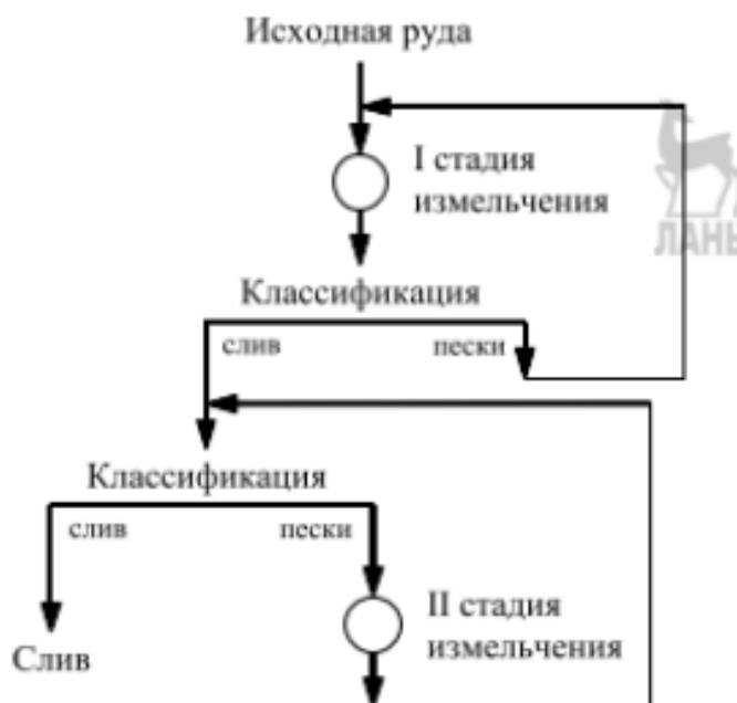
Рисунок 2.4 - Классическая схема двухстадиального измельчения с замкнутым циклом в I и II стадиях
