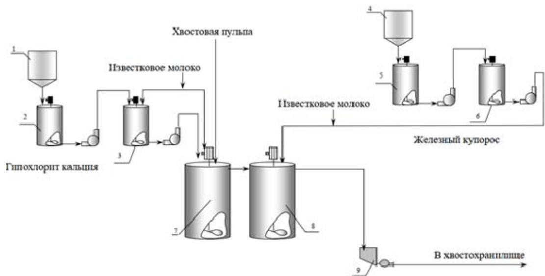
Рисунок 2.5 - Рекомендуемая схема обезвреживания хвостов сорбционного выщелачивания при переработке руд месторождения Кулуджун.
