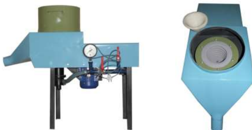
Рис. 5.6.4 – Сепаратор-концентратор URALGOLD СК-007-800
