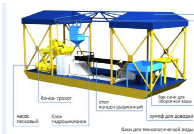
Рисунок 5.9. Установка для механизированной обработки шлиховых проб
