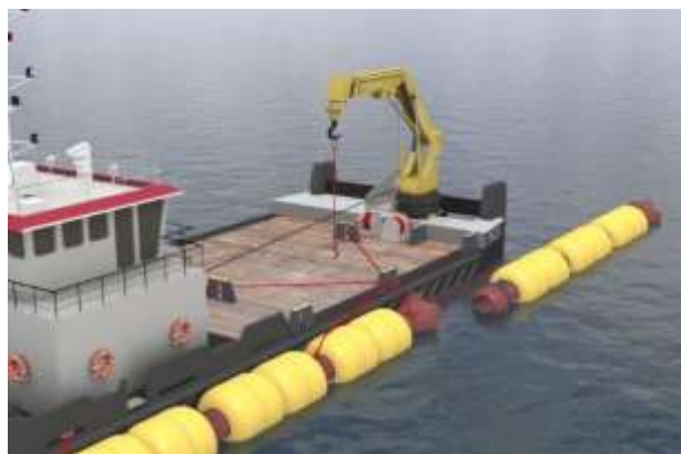
Рисунок 7.1 Собранный плавающий трубопровод, подсоединенный к дноуглубительному снаряду
