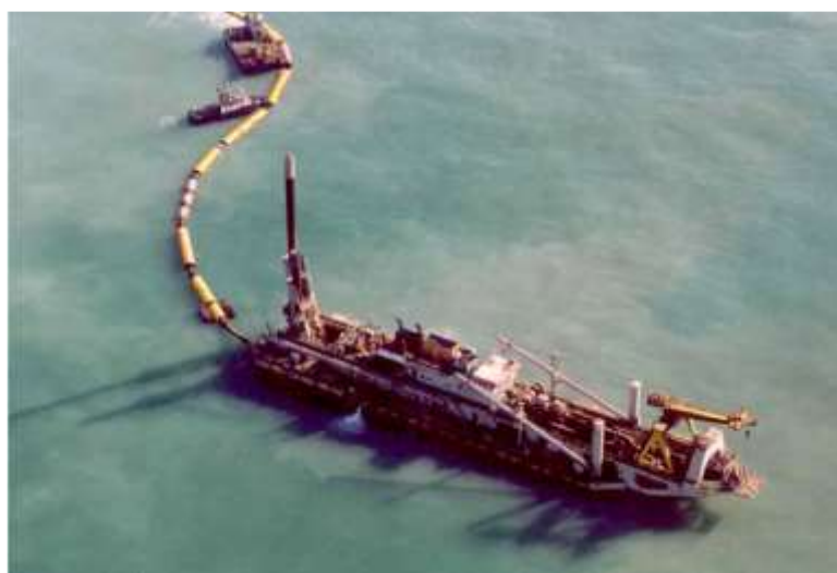
Рисунок 7.4. Принцип работы фрезерного земснаряда
