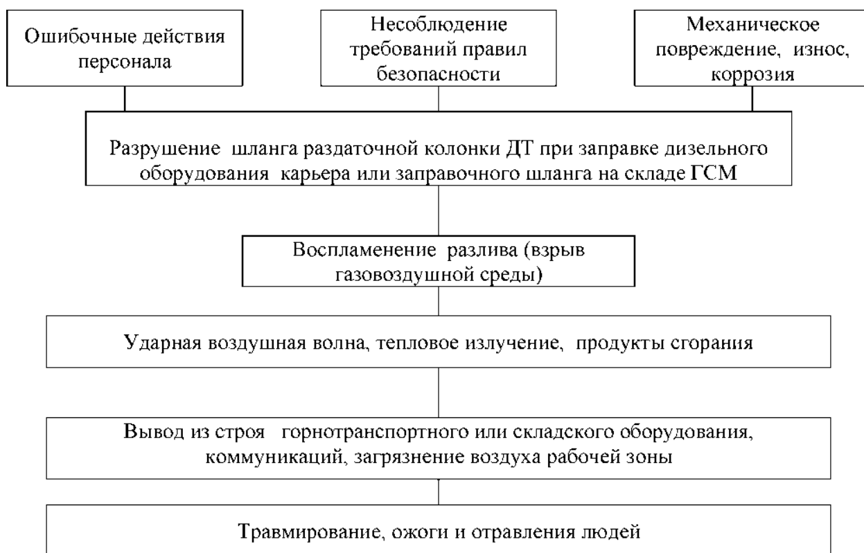
Рис. 11.3 - Блок-схема вероятного сценария возникновения и развития аварии при заправке дизельного технологического оборудования карьера из топливозаправщика или заправке емкости на складе ГСМ
