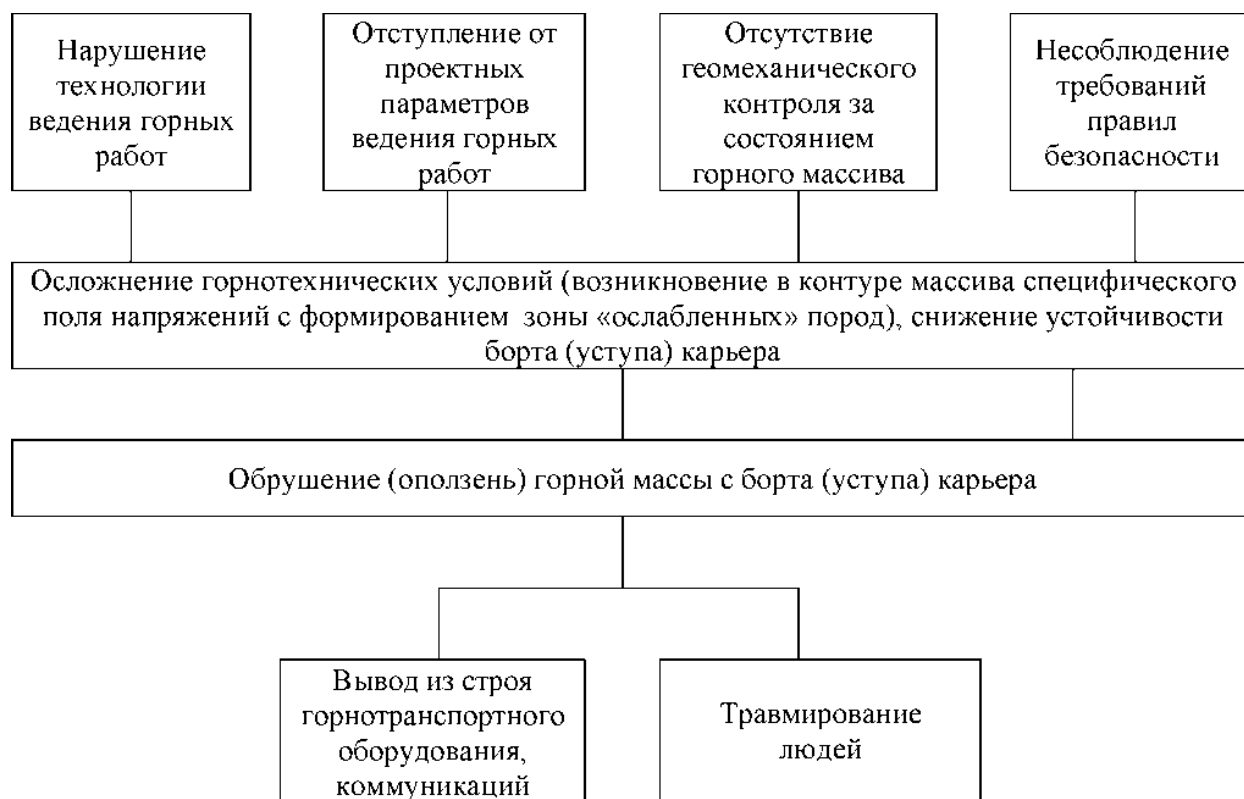
Рис. 11.1 - Блок-схема вероятного сценария аварии при обрушении (оползней) горной массы с борта (уступа) карьера
