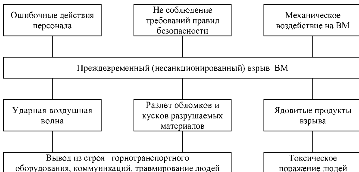
Рис. 11.2 - Блок-схема вероятного сценария аварии при преждевременном (несанкционированном) взрыве ВВ при проведении взрыва в блоке с механизированным заряданием скважин
