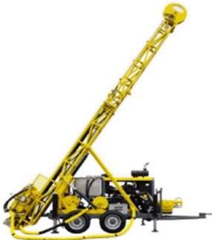
Рисунок 8. Буровая установка марки Epiroc Boyles C6
