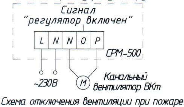
Схема подключения вентилятора к симисторному регулятору
