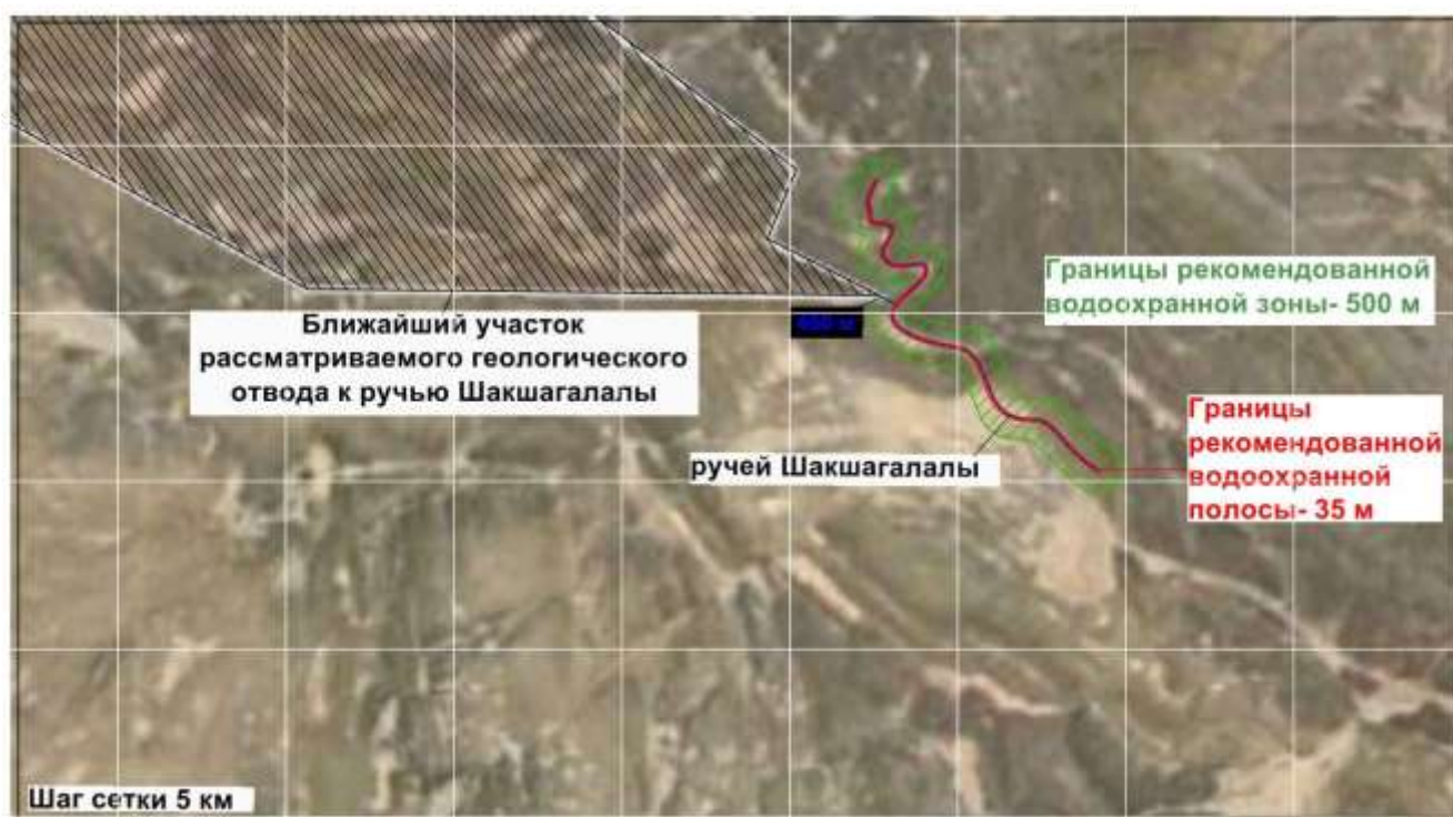
Рисунок 3.1 – Ситуационная карта-схема участка работ с нанесением ВЗ и ВП ручья Шакшагалалы
