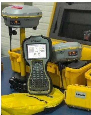
Рис. 3. Комплект GPS приемников Trimble R8S
