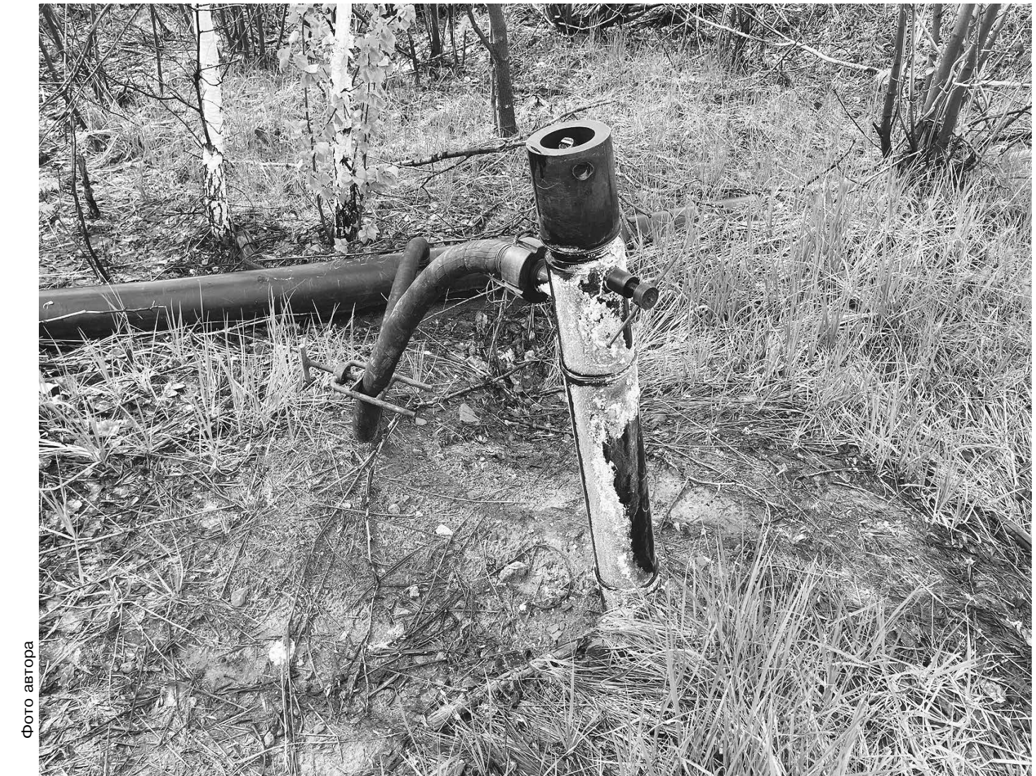
Далматовское, следы протечек на скважинах
