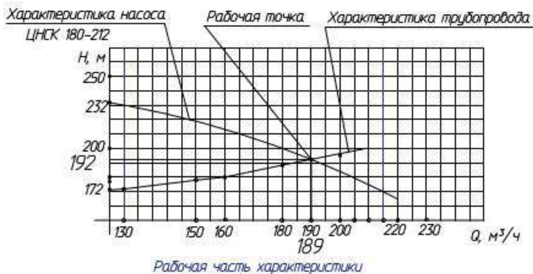
Рисунок 1. Совмещенная характеристика насосного агрегата ЦНСША 180-212 с напорным трубопроводом для участковой насосной горизонта минус 130 м
