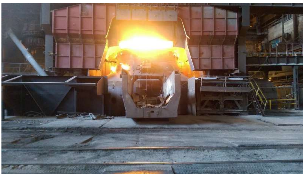
Рисунок 6.2 – Процесс продувки на конвертере № 1
