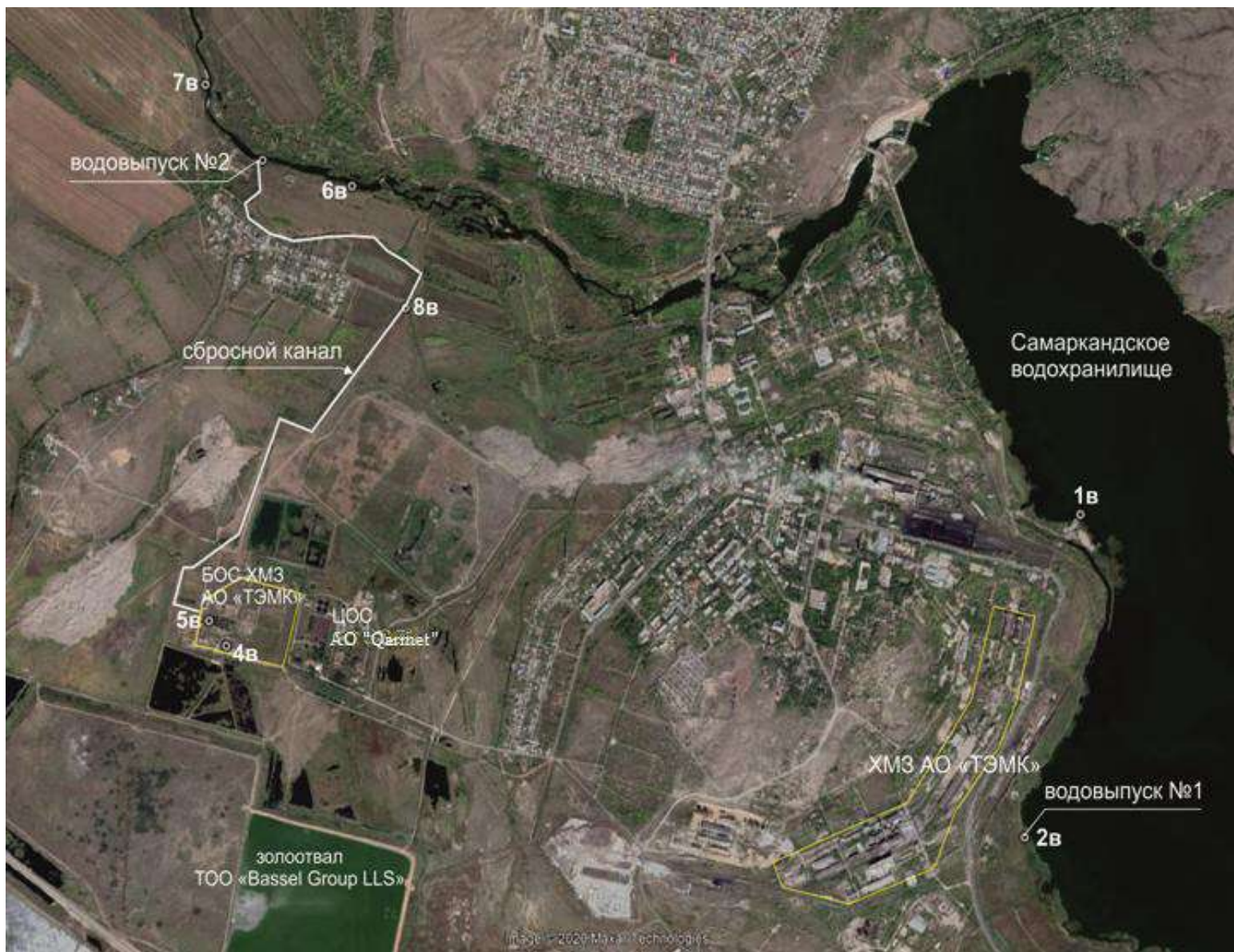
Рисунок 1.2 - Карта-схема предприятия с указанием очистных сооружений, мест выпусков, фоновых и контрольных створов
