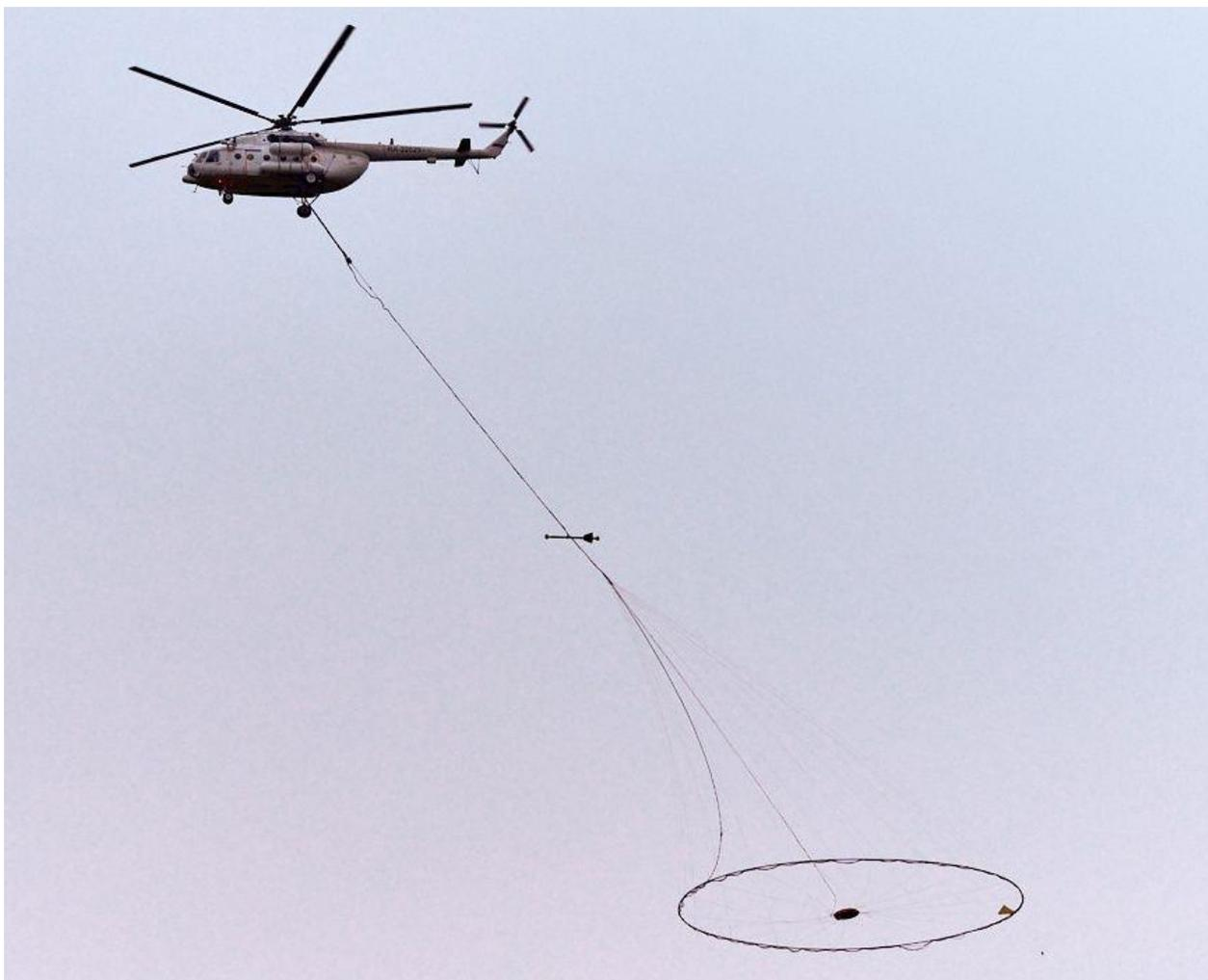
Рис. 4.7 Выполнение аэро-электроразведки
