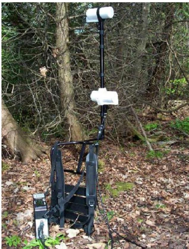
Рис. 4.3 Магнитометр GSM-19 в рабочем положении
