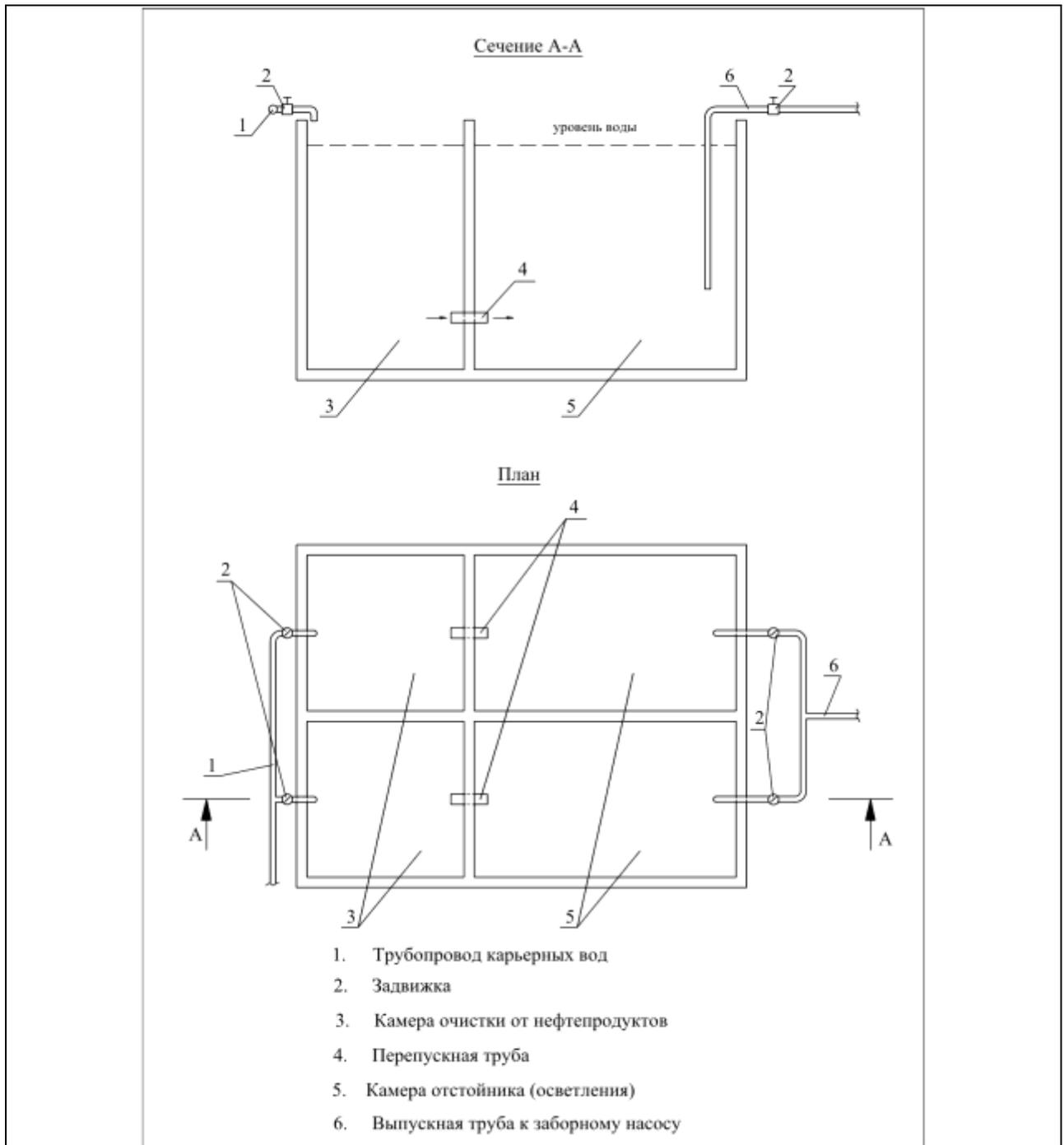
Рис. 10.1 Схема устройства приемного очистного резервуара
