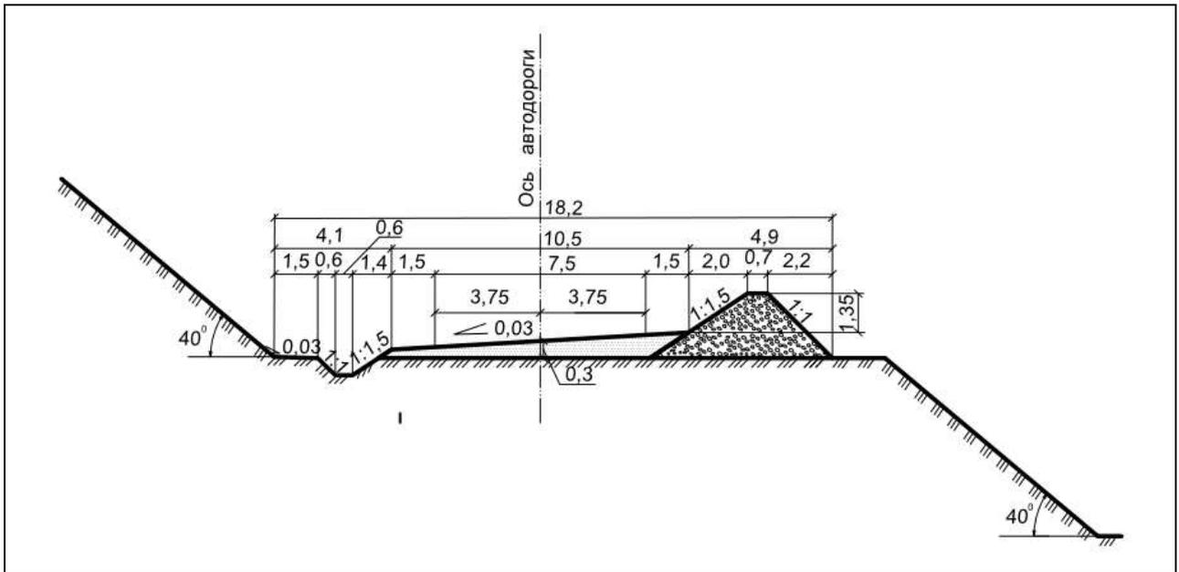
Рис. 9.1 Типовое поперечное сечение внутрикарьерной технологической автодороги с основанием из рыхлых пород
