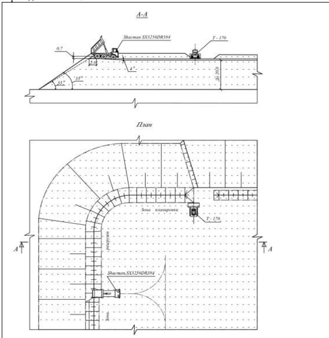
Рис. 8.1 Технологическая схема бульдозерного отвалообразования
