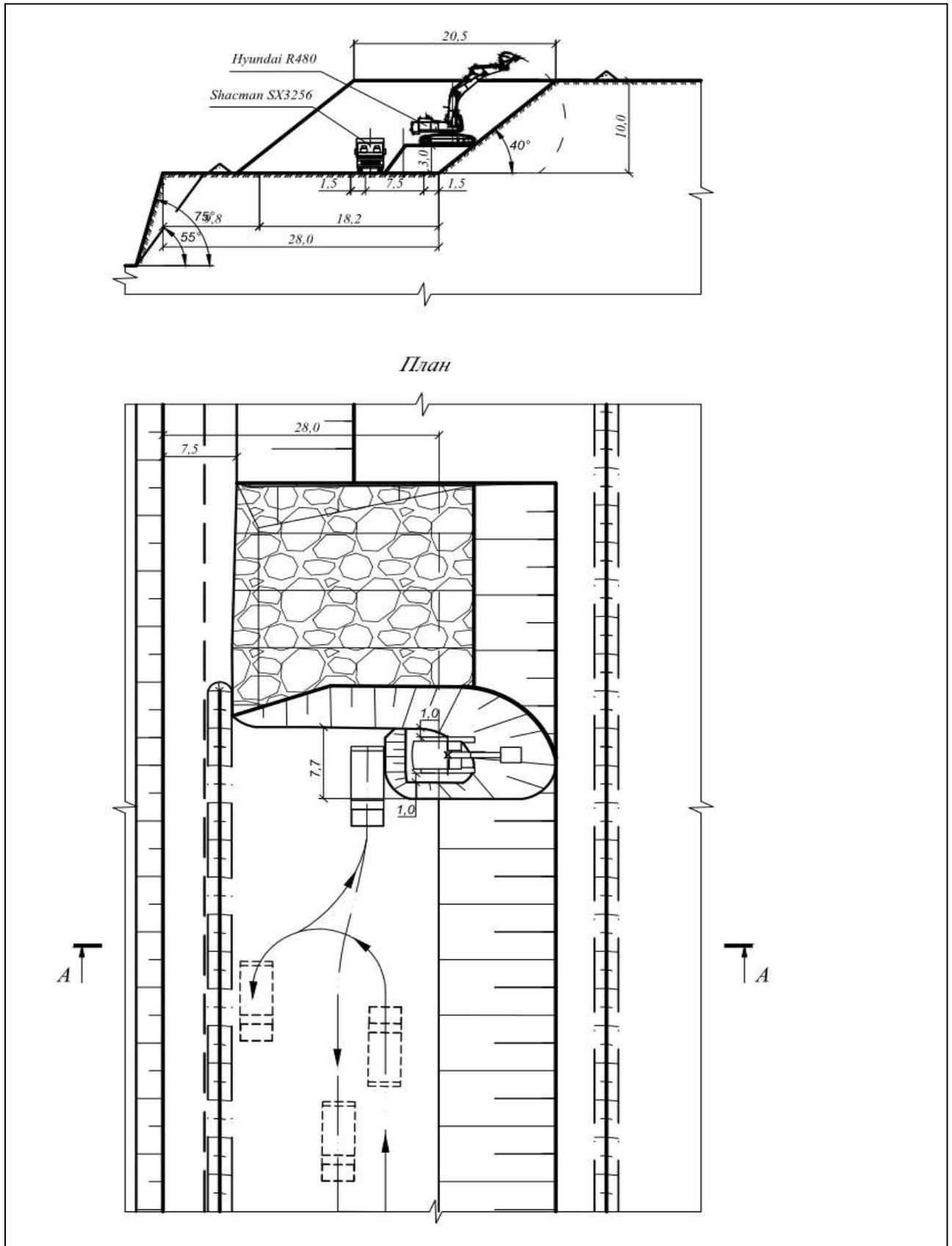
Рис. 7.2 Технологическая схема отработки вскрышного уступа в рыхлых породах
