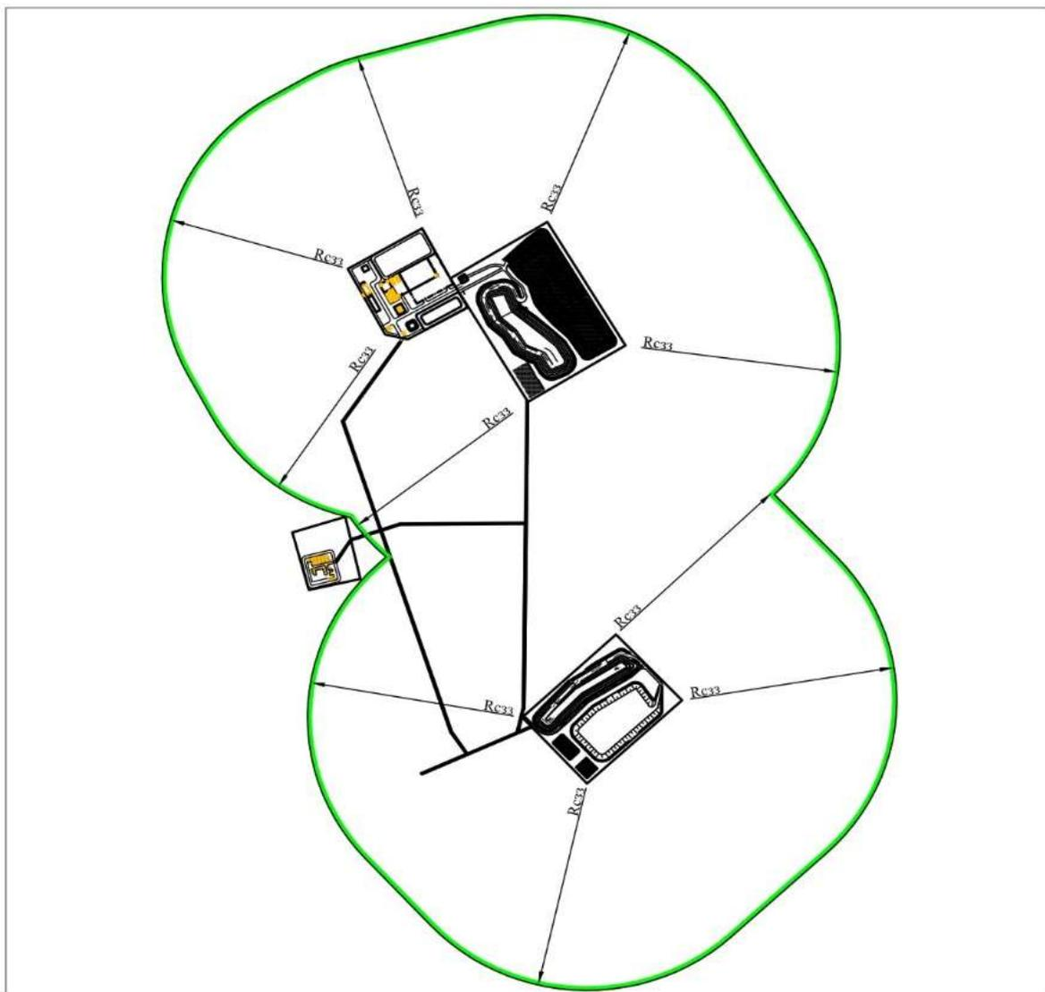
Рис. 15.1 Схема границ С33 производственных объектов рудника «Прогресс»
