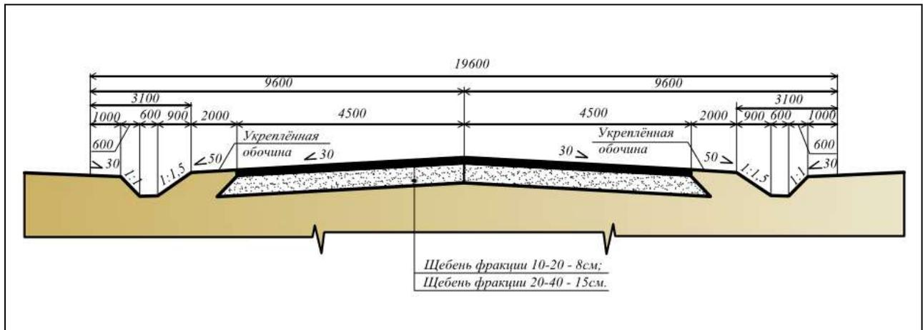
Рис. 9.3 Типовое поперечное сечение внутриплощадочной (межплощадочной) технологической автодороги
