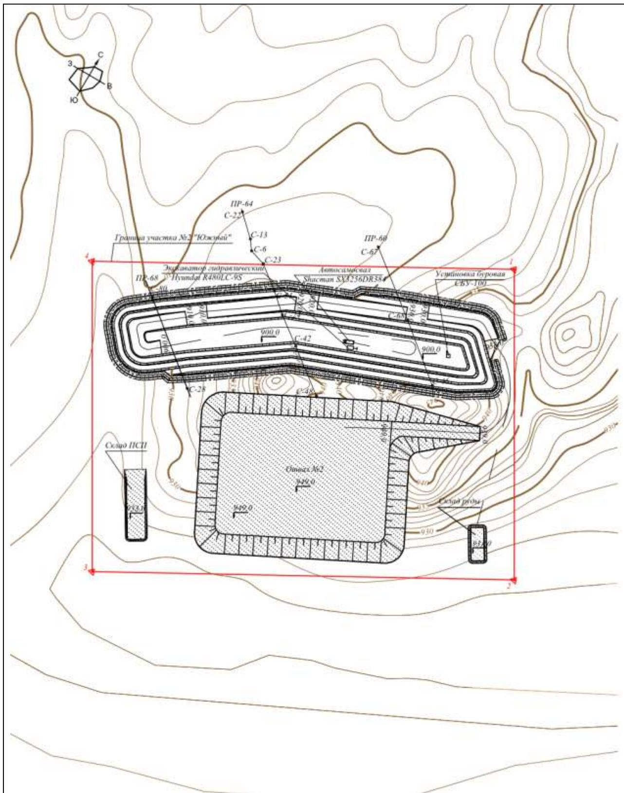
Рис. 6.3 План горных работ карьера на конец отработки
