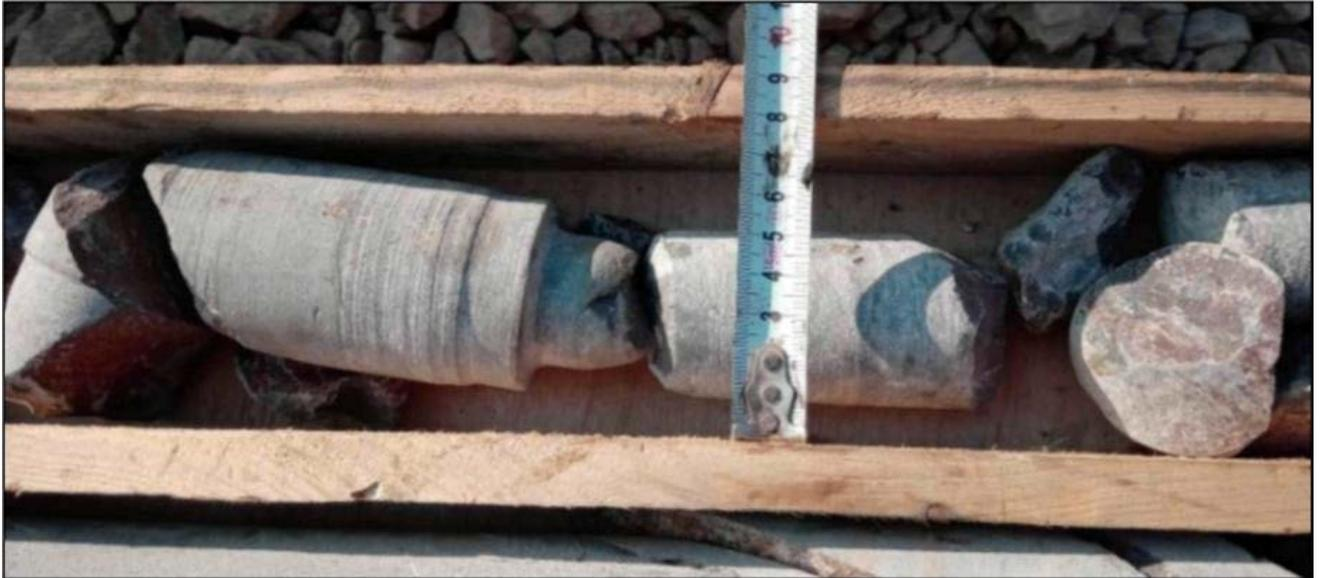
Рис. 5.3 Проверка качества и отсутствие кернового материала
