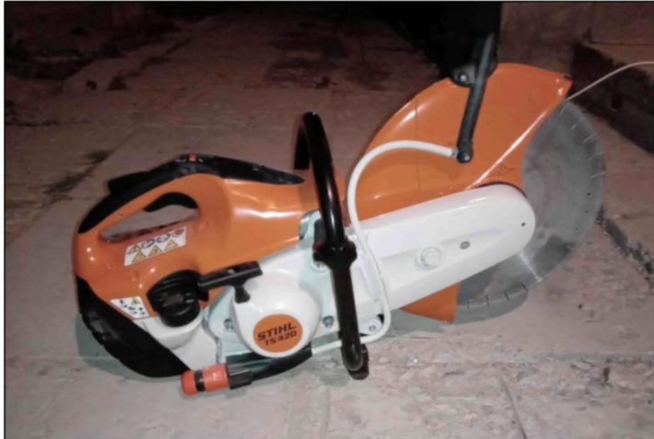
Рис. 5.1 Бензорез для отбора бороздовых проб
