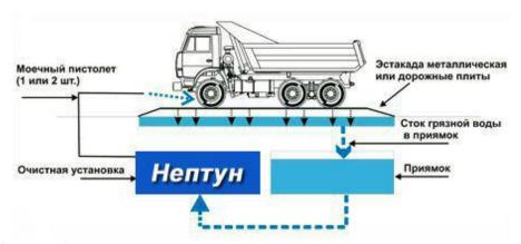
Технологический процесс мойки (очистки) колёс автотранспорта:
