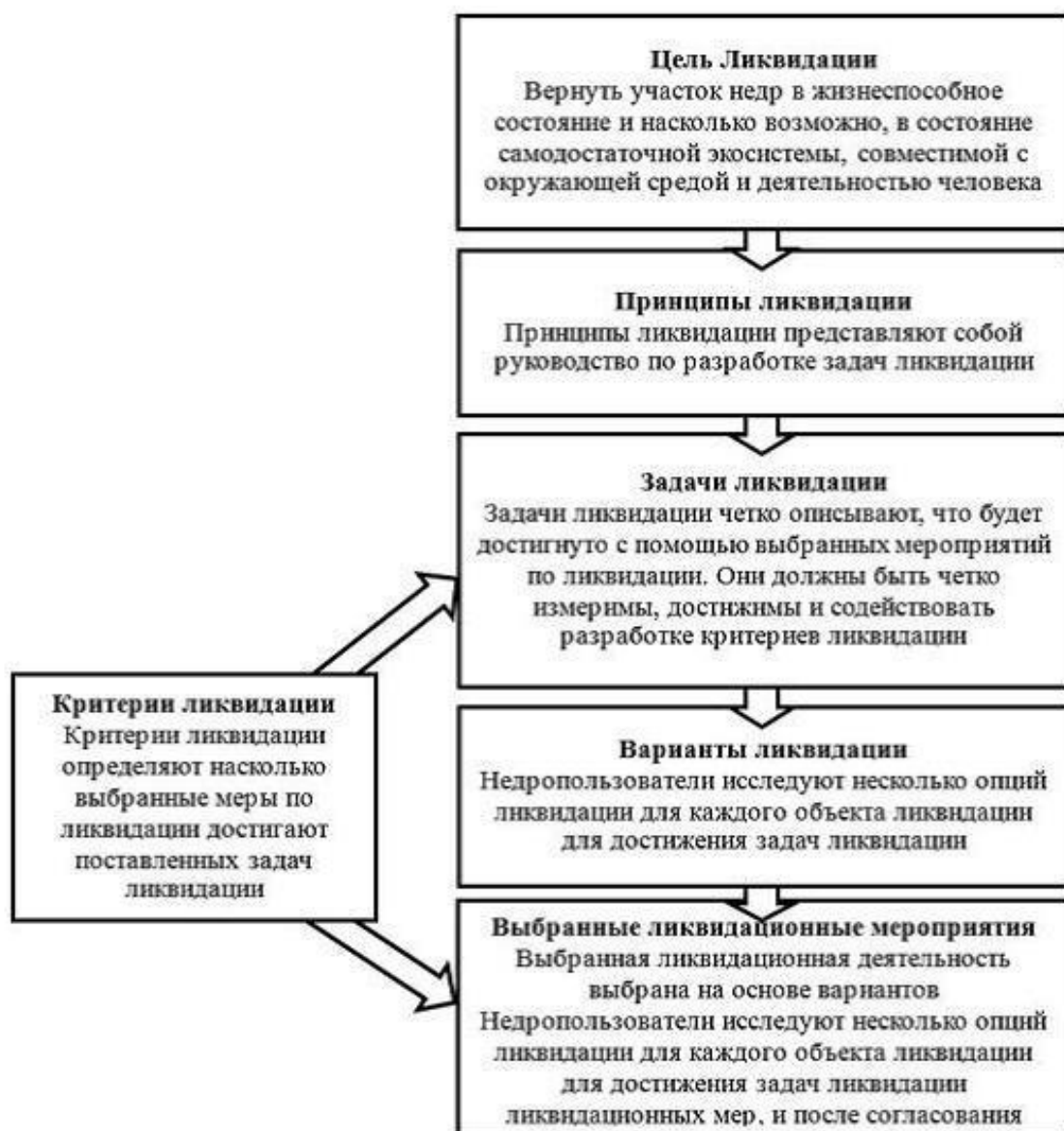
Рис.7.3.1 Схема планирования ликвидации
