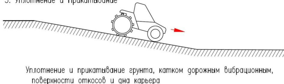
Рис. 7.3.2 Принципиальная схема рекультивации грунтовых карьеров
