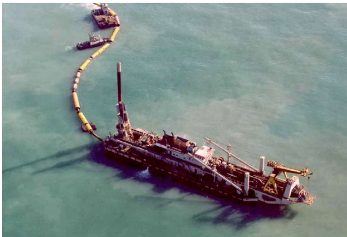
Рисунок 7.4. Принцип работы фрезерного земснаряда
