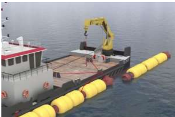
Рисунок 7.1 Собранный плавающий трубопровод, подсоединенный к дноуглубительному снаряду
