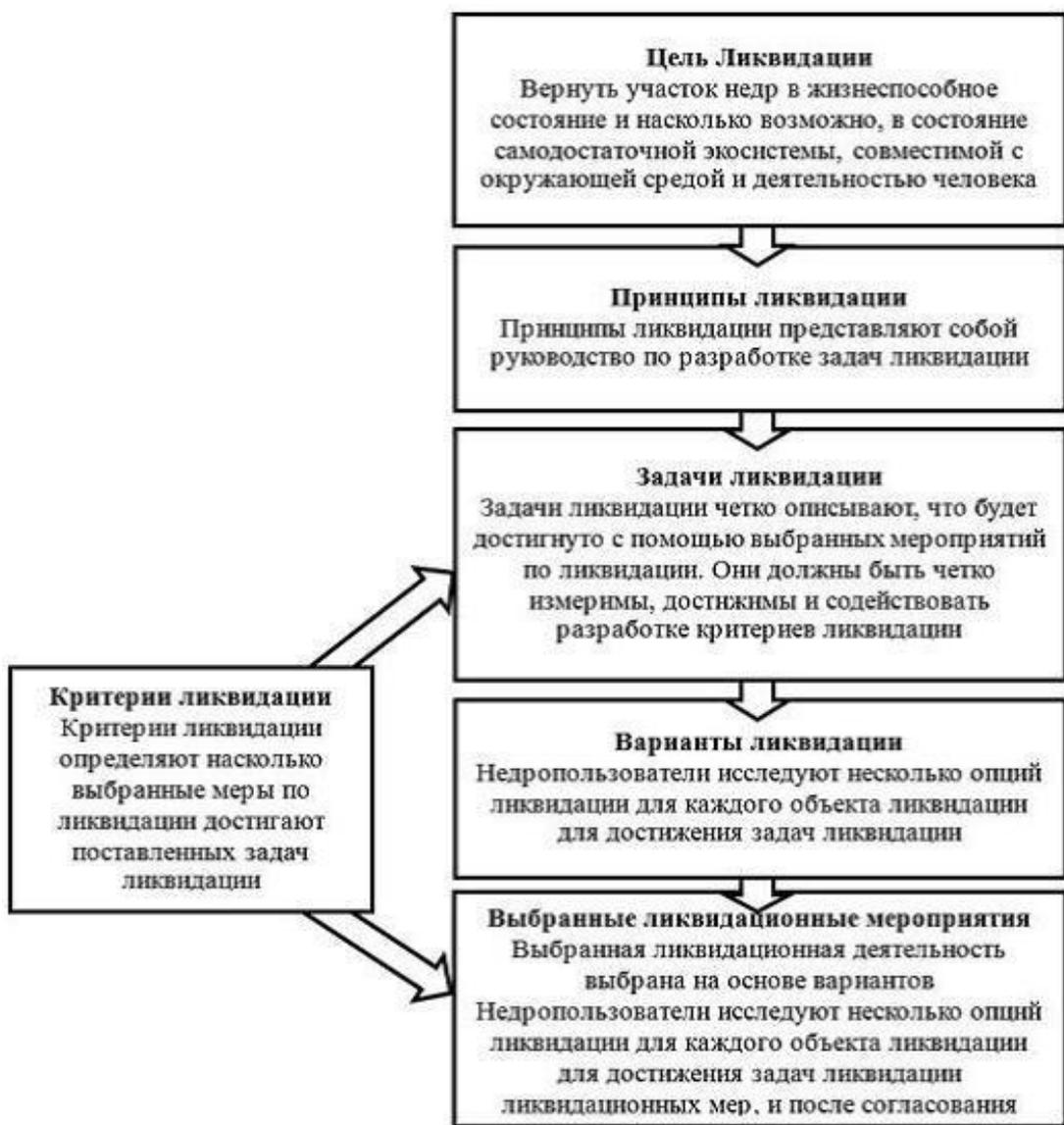
Рис.7.3.1 Схема планирования ликвидации
