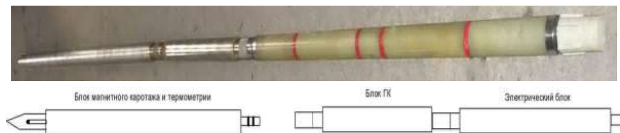
Рис. 3.1 Каротажный скважинный снаряд ПРК-4203
