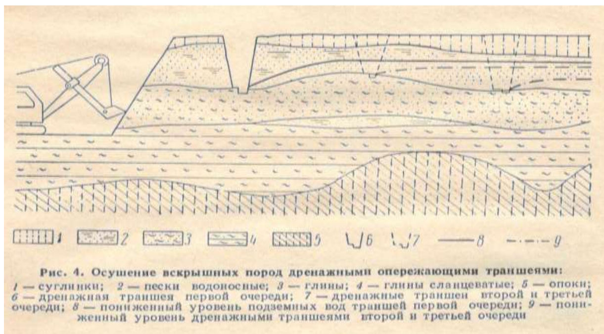
Рис 4.1 Осушение вскрышных пород дренажными опережающими траншеями
