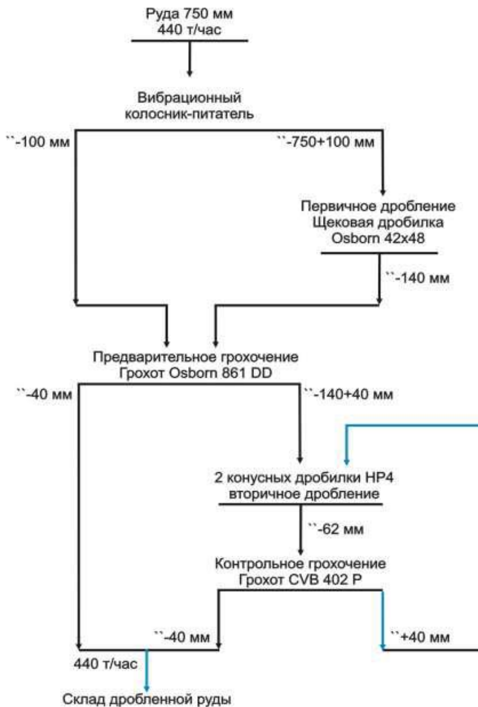
Рисунок 2.1 - Технологическая схема дробления
