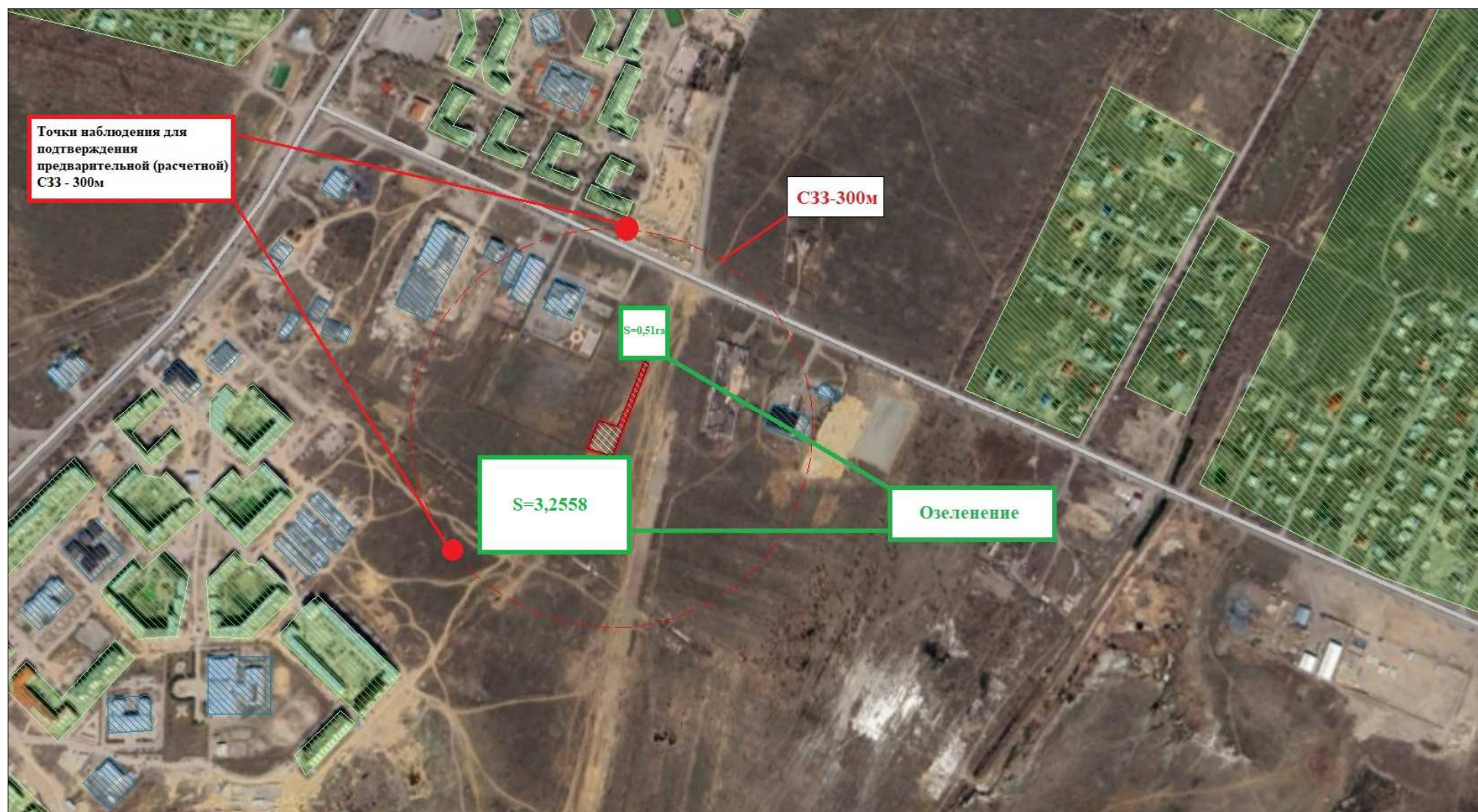
Рисунок 8.11 – Размещение точек наблюдения для подтверждения предварительной (расчетной) СЗЗ, а также схема предлагаемого озеленения территории СЗЗ площадки по производству бетона ТОО «СМУ-5»
