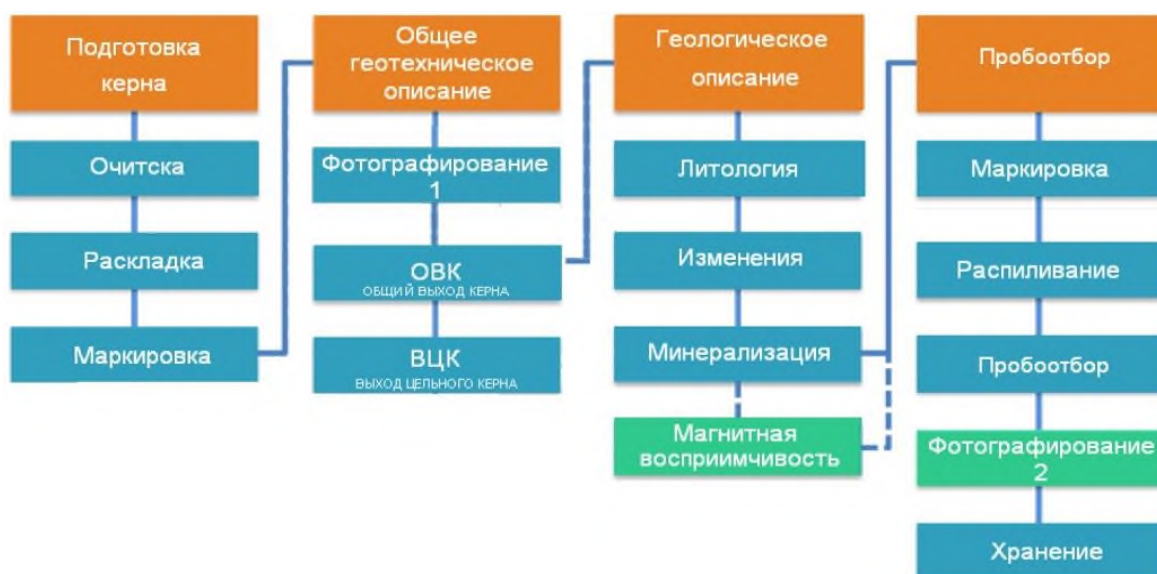
Рис. 4 Технологическая схема документации и обработки керна
