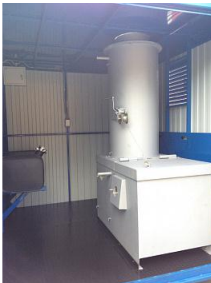
Рисунок 1.2 - Мобильная печь-инсинератор модели ИНСИ В-150
