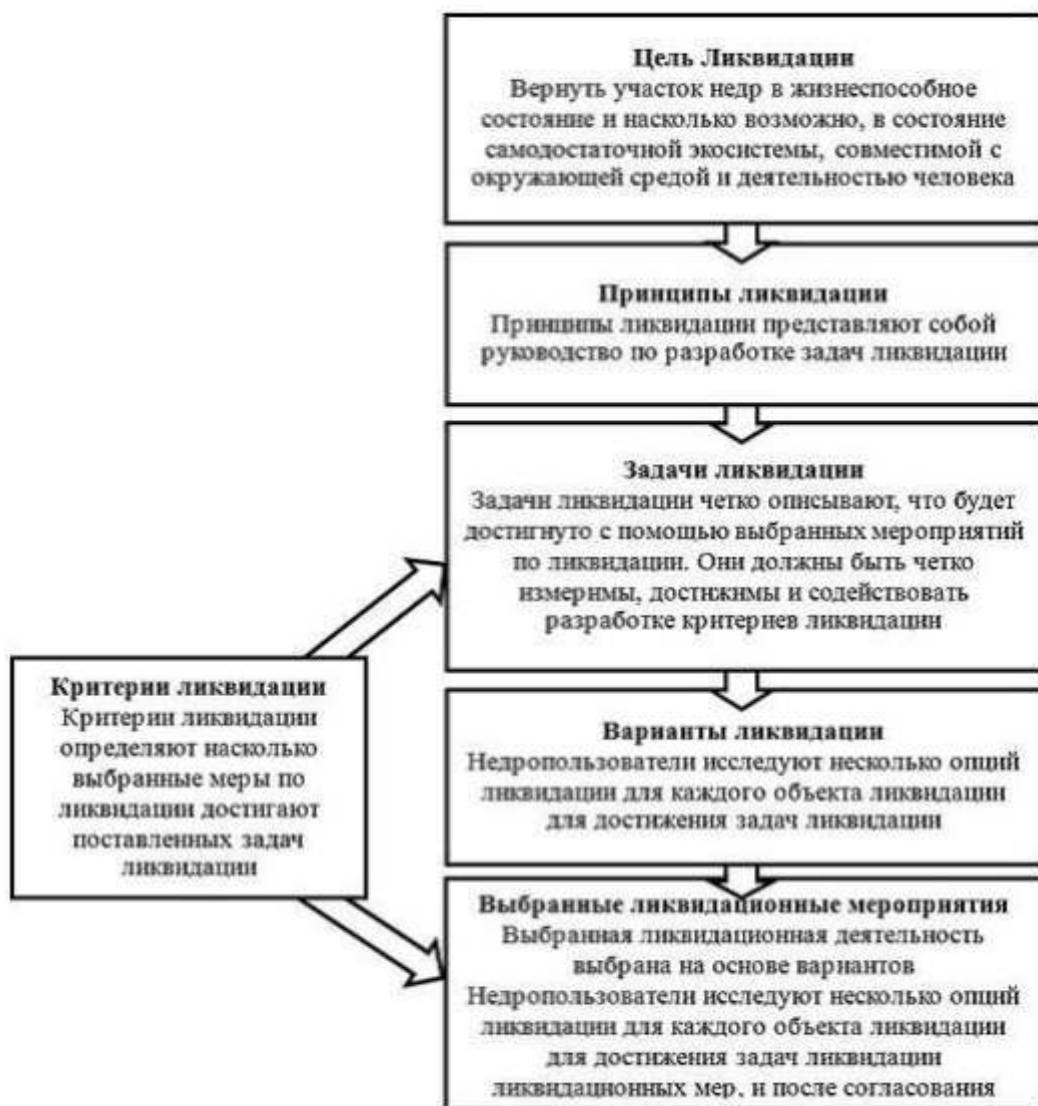
Рис.7.3.1 Схема планирования ликвидации
