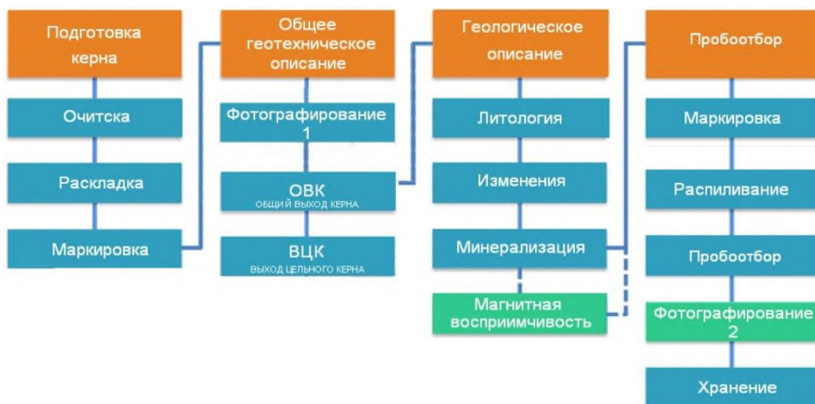
Рис. 3 Технологическая схема документации и обработки керна
