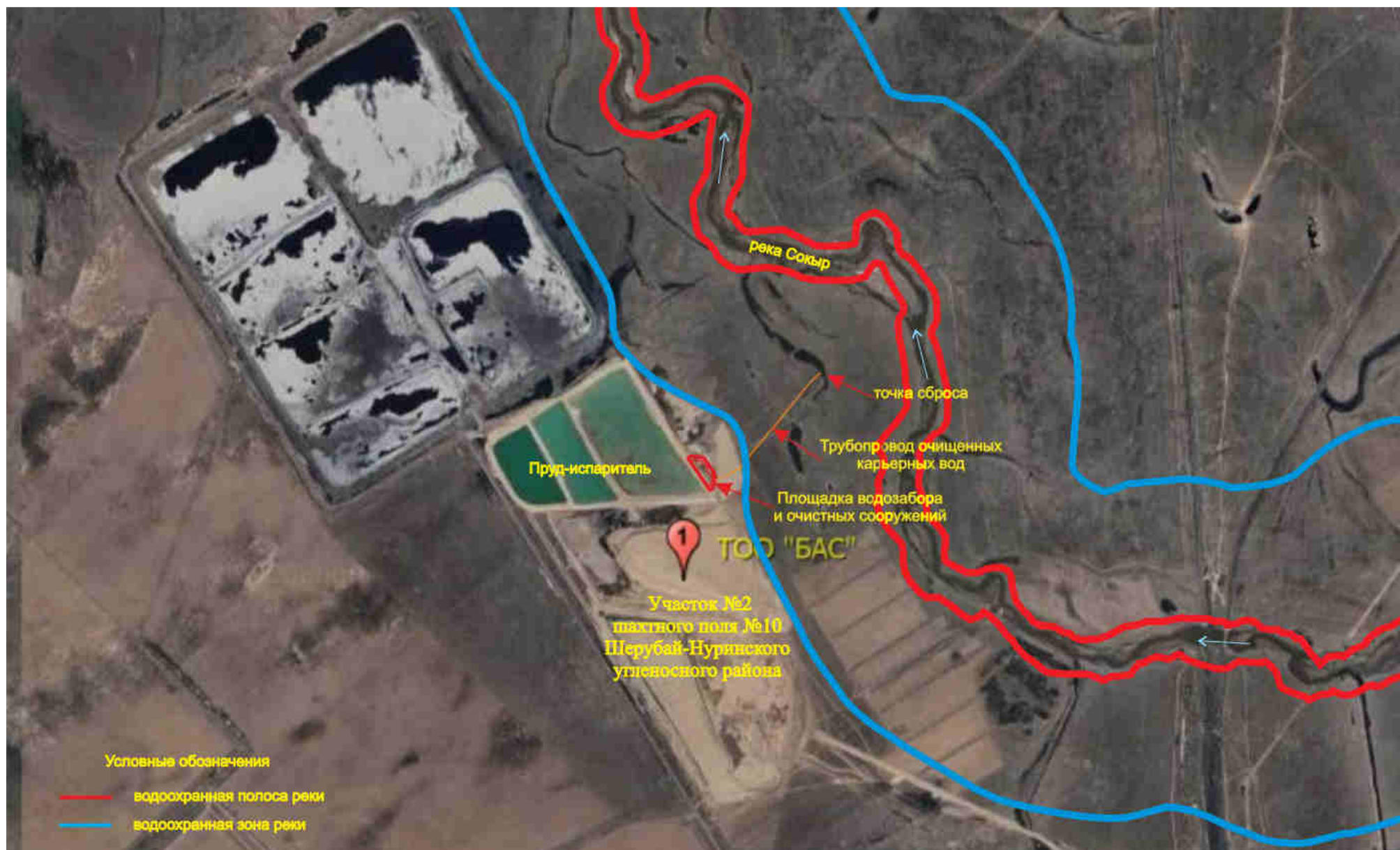
Рис. 3 Взаиморасположение проектируемых объектов (площадки очистных сооружений, отводящего трубопровода) относительно реки Соқыр и водоохранных зон и полос реки
