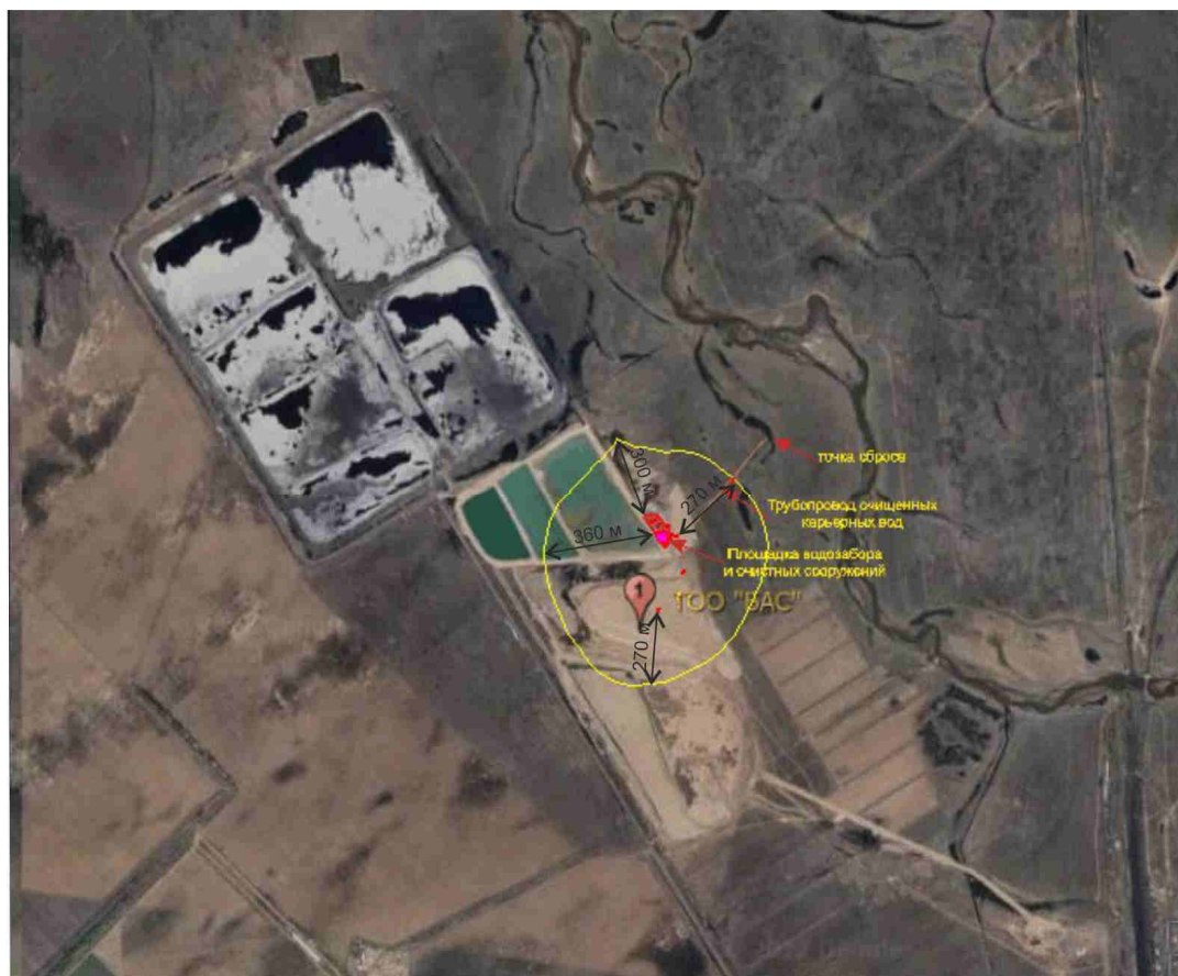
Рисунок 2. Граница области химического воздействия на атмосферный воздух при проведении работ по реконструкции системы водоотлива попутно-добываемых карьерных вод
