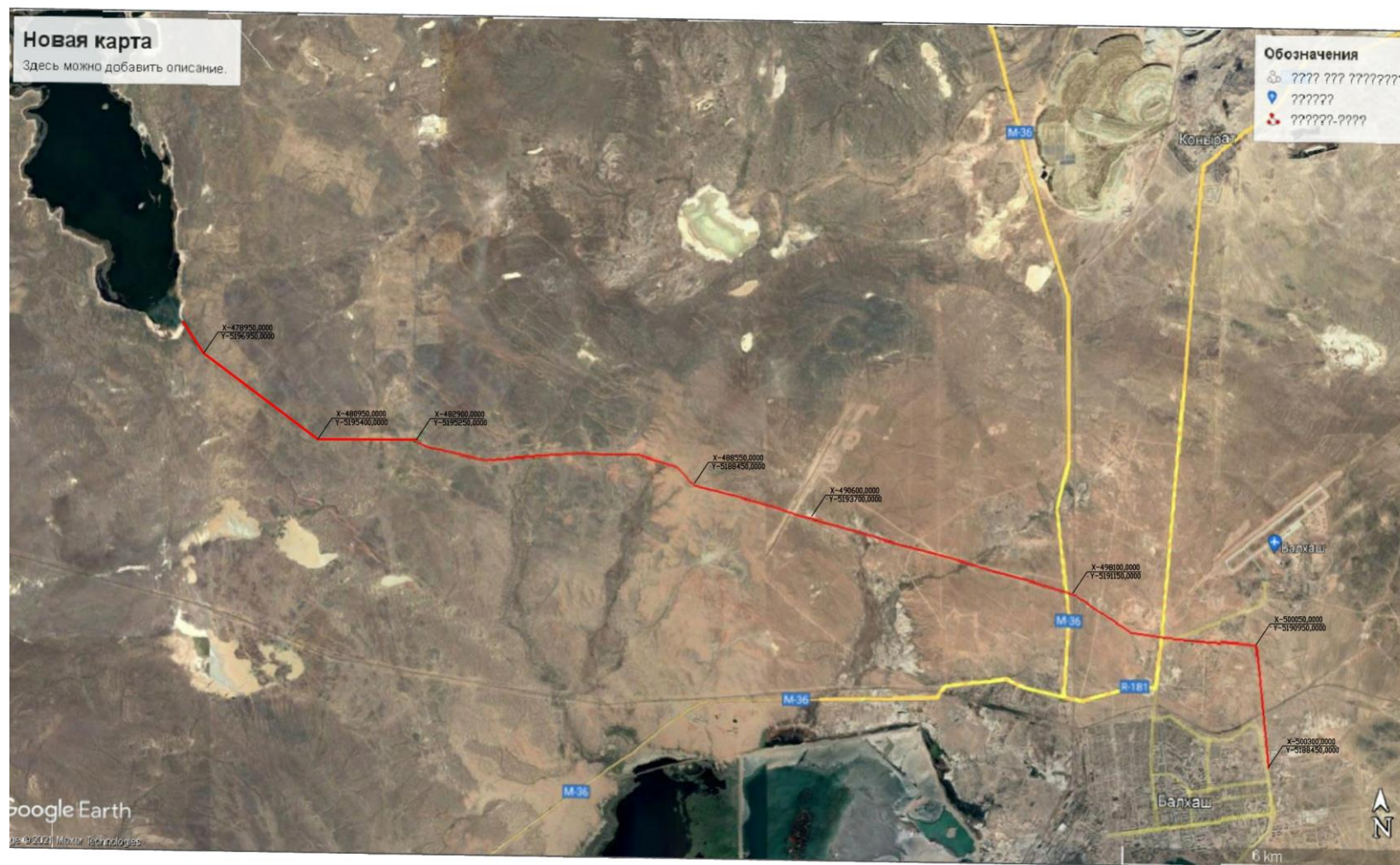
Рисунок 3 Схема существующего коллектора в пруд-испаритель Кок-Домбак
