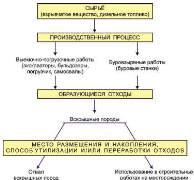
Рисунок 2.1.1. - Схема производственных процессов на карьере
