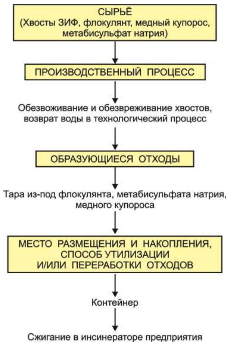
Рисунок 2.1.19. - Схема производственных процессов на участке сгушения
