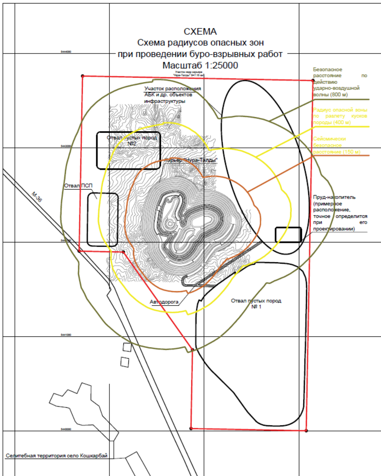
Рисунок 2.1 Схема радиусов опасных зон при проведении БВР
