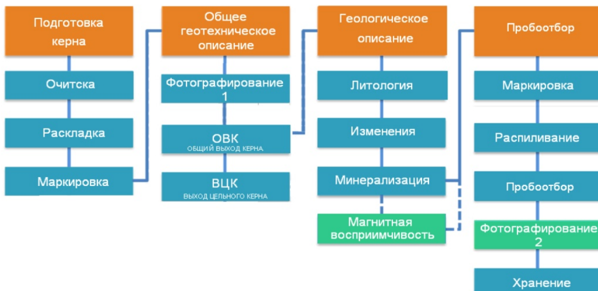
Рис. 5 Технологическая схема документации и обработки керна
