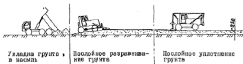
Рис. 9.2.1. Технология возведения насыпи.
