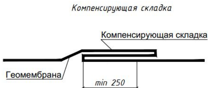
Рисунок 3 – Схема компенсирующей складки.
