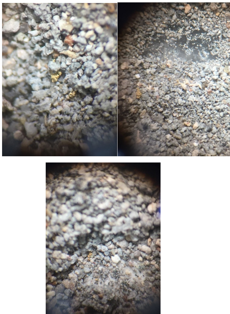
Рисунок 20 - Фотографии в образцов ВЦО при 10-ти кратном увеличении с видимыми включениями сплавов ДМ
