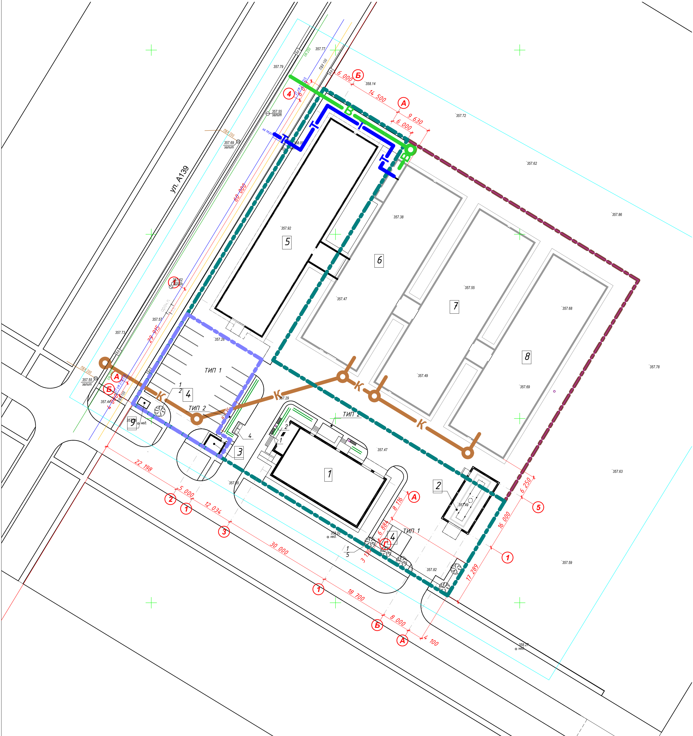
План инженерных сетей м 1:500
