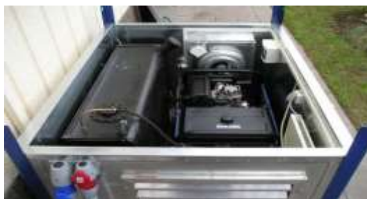
Рис. 1.16 Дизельный генератор SDMO X 180/4DE мощностью 5 кВт в миниконтейнере
