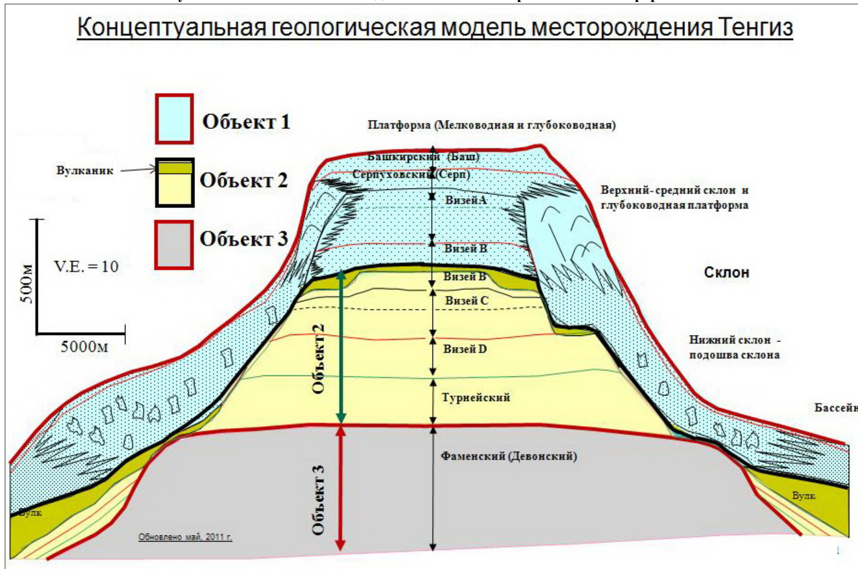
Рисунок 1.2. Геологическая модель Тенгизской карбонатной платформы
