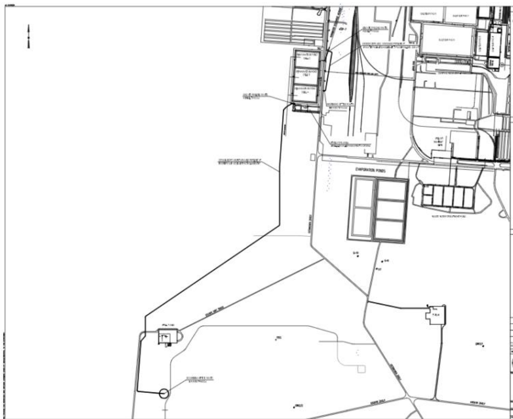
Рис.5. Ситуационная схема 6" линия от U600 до стояка ЗТП (6" наземный трубопровод технической воды) (ЗТП) U600-3GP / T-3948.
