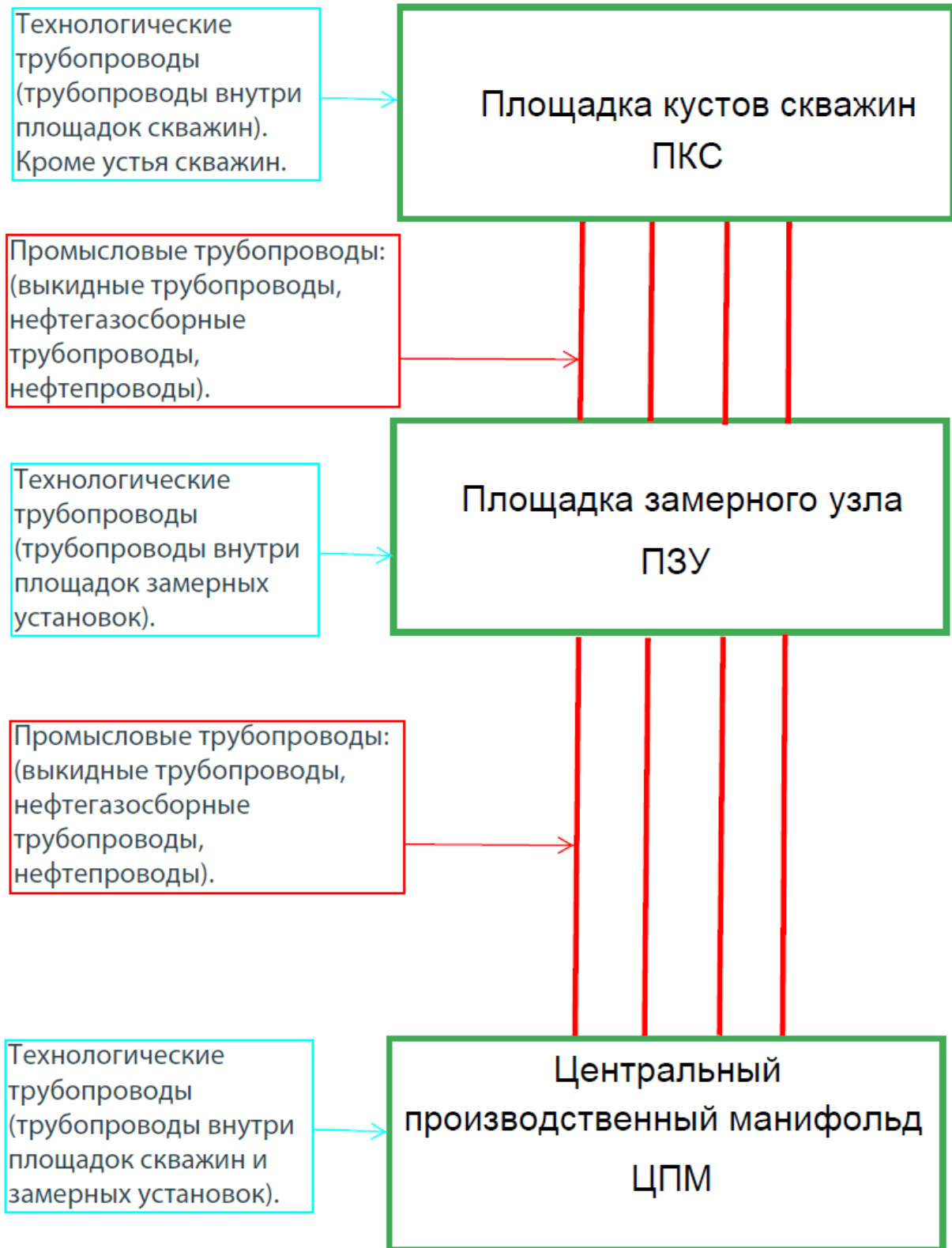
Рисунок 5.12.1. Схема технологических и промышленных трубопроводов:
